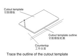
on the countertop with a pencil at the desired installation location. 用铅笔在厨房工作台面上您希望 安装水槽的位置画下切割模板的轮廓。
