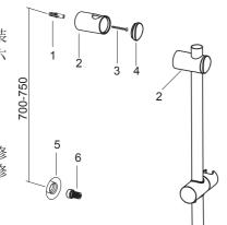
根据胀塞(1)直径,距离管道配件中心 700-750mm钻孔。将胀塞塞入孔中。
