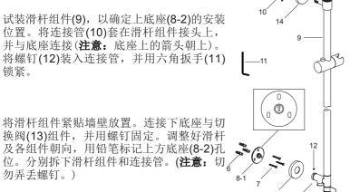
根据胀塞直径在标记处钻孔。将胀塞塞入孔中,用螺钉固 定上底座(8-2)。将连接管(10)装入到底座(8-2)中,并锁紧 螺钉。将滑杆组件连同装饰罩(14)装在上下底座上。用六 角扳手将滑杆与连接管, 切换阀与下底座的螺钉旋入并锁 紧。将装饰罩后推与底座旋紧直至接触墙面。
