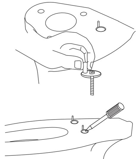
1. 将铰链插入安装孔，装上膨胀管和螺母，用螺丝刀在铰链顶部将螺丝微紧(对于另一种安装，膨胀管不予提供)。
