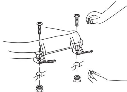
1. 掰开盖在盖板螺栓孔上面的两个铰链盖或铰链帽。
