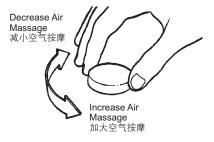
旋转喷头中心旋钮调节按摩力度大小。
