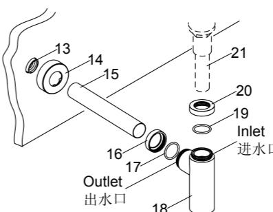
**注意：**确保尾管插入进水连接螺帽不少于25毫米。
