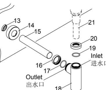
**注意：**确保横管插入出水口及排水口长度均不少于25毫米。
