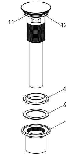
**注意：**如果需要，可在排水器盘片(11)底面沿周围涂一圈密封油灰或其它密封剂，而不使用橡胶垫片(12)。
